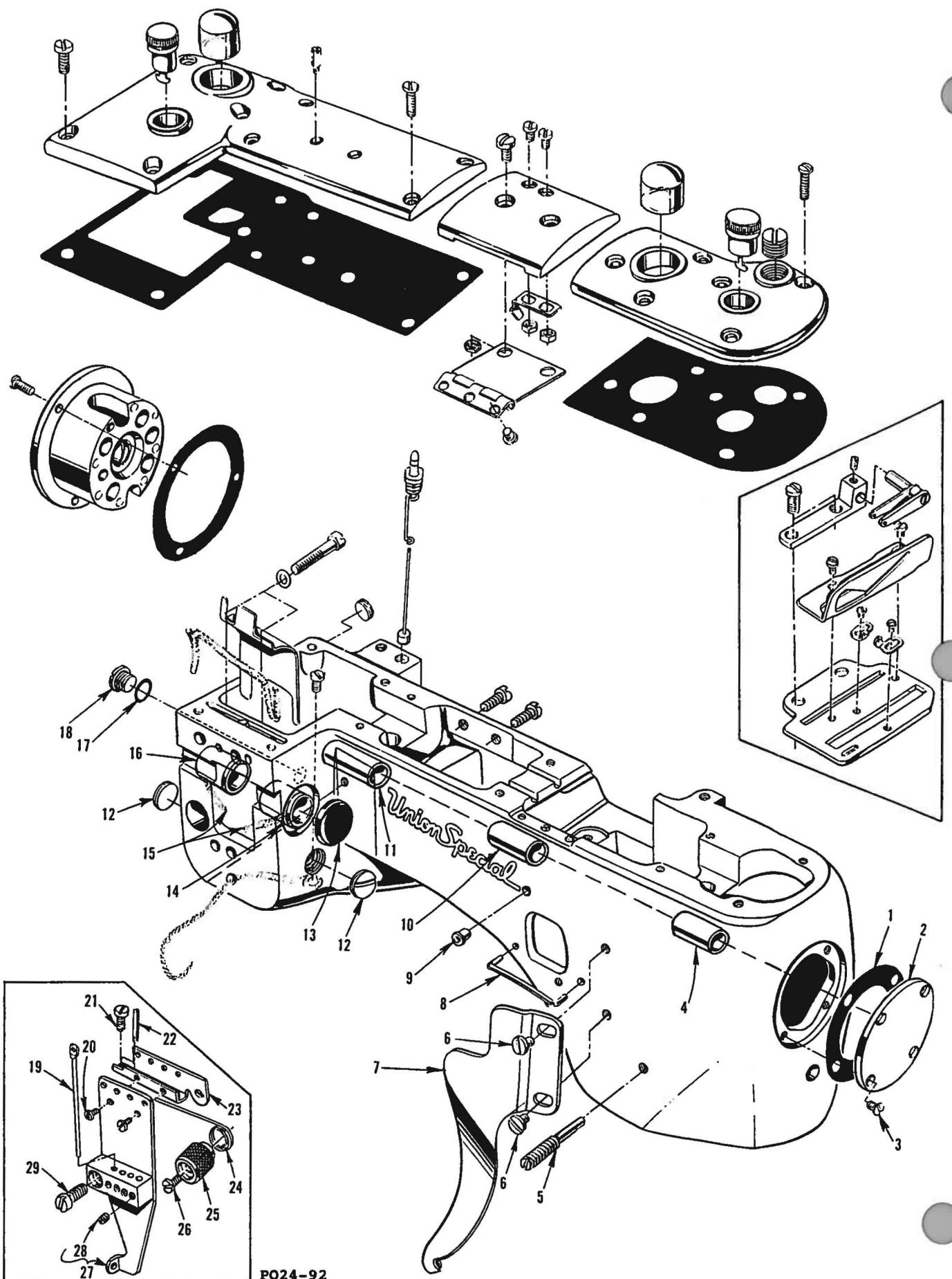
**MAIN FRAME, BUSHINGS & MISCELLANEOUS EYELET & COVER PARTS**
