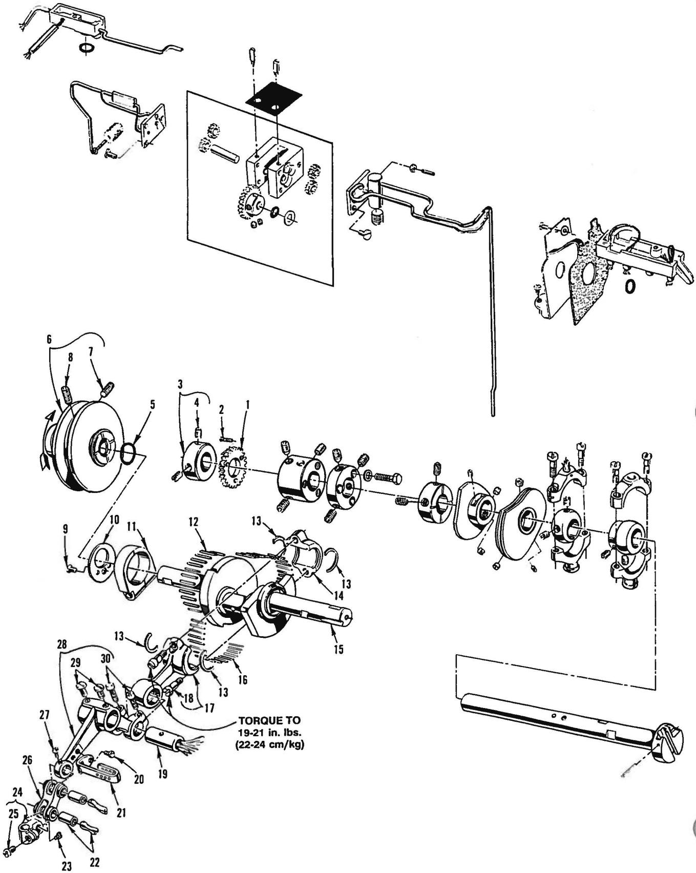
**CRANKSHAFT & NEEDLE LEVER PARTS**
